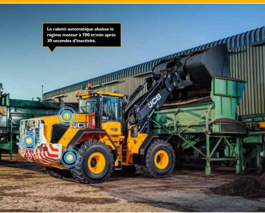
Pour économiser le carburant, la fonction d'arrêt automatique du moteur peut serrer les freins et couper le moteur de la machine en toute sécurité après une durée programmable.
