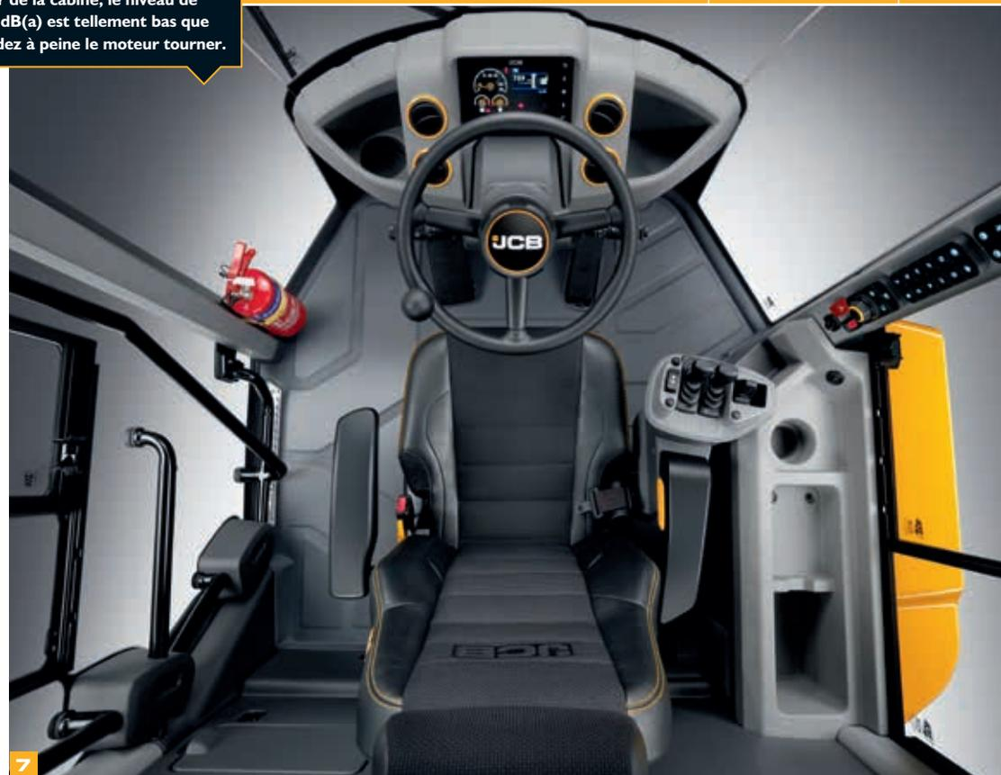
**8** La fonction de réglage et de mémorisation de la position du volant de direction ramène instantanément le volant à sa position de prédilection, même après avoir été rabattu pour un accès plus aisé.
