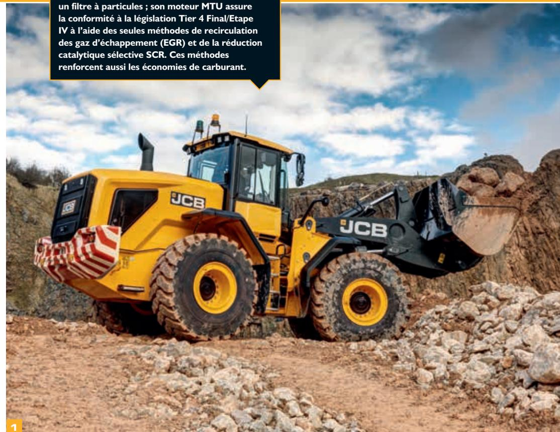
Sur votre JCB 457, vous ne devez pas vous soucier de perdre du temps et de l'argent en remplaçant un filtre à particules ; son moteur MTU assure la conformité à la législation Tier 4 Final/Etape IV à l'aide des seules méthodes de recirculation des gaz d'échappement (EGR) et de la réduction catalytique sélective SCR. Ces méthodes renforcent aussi les économies de carburant.
