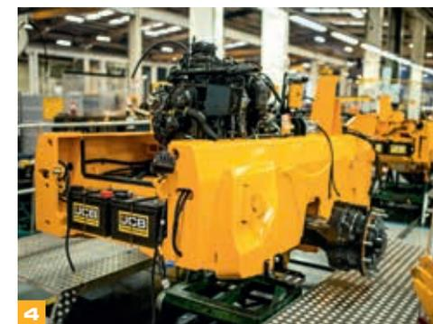
L'articulation de la chargeuse sur pneumatiques JCB 457 présente une section caissonnée extra-robuste, beaucoup plus résistante qu'une simple plaque avec bossage. Ses vérins de direction sont en position haute et bien protégés contre les éventuels chocs et dommages sur le chantier.
