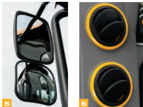
**6** Un tout nouveau système de ventilation avec neuf orifices de désembuage et six orifices opérateur assurent une visibilité et un confort de l'opérateur permanents. Son fonctionnement est en outre ultra-silencieux.
