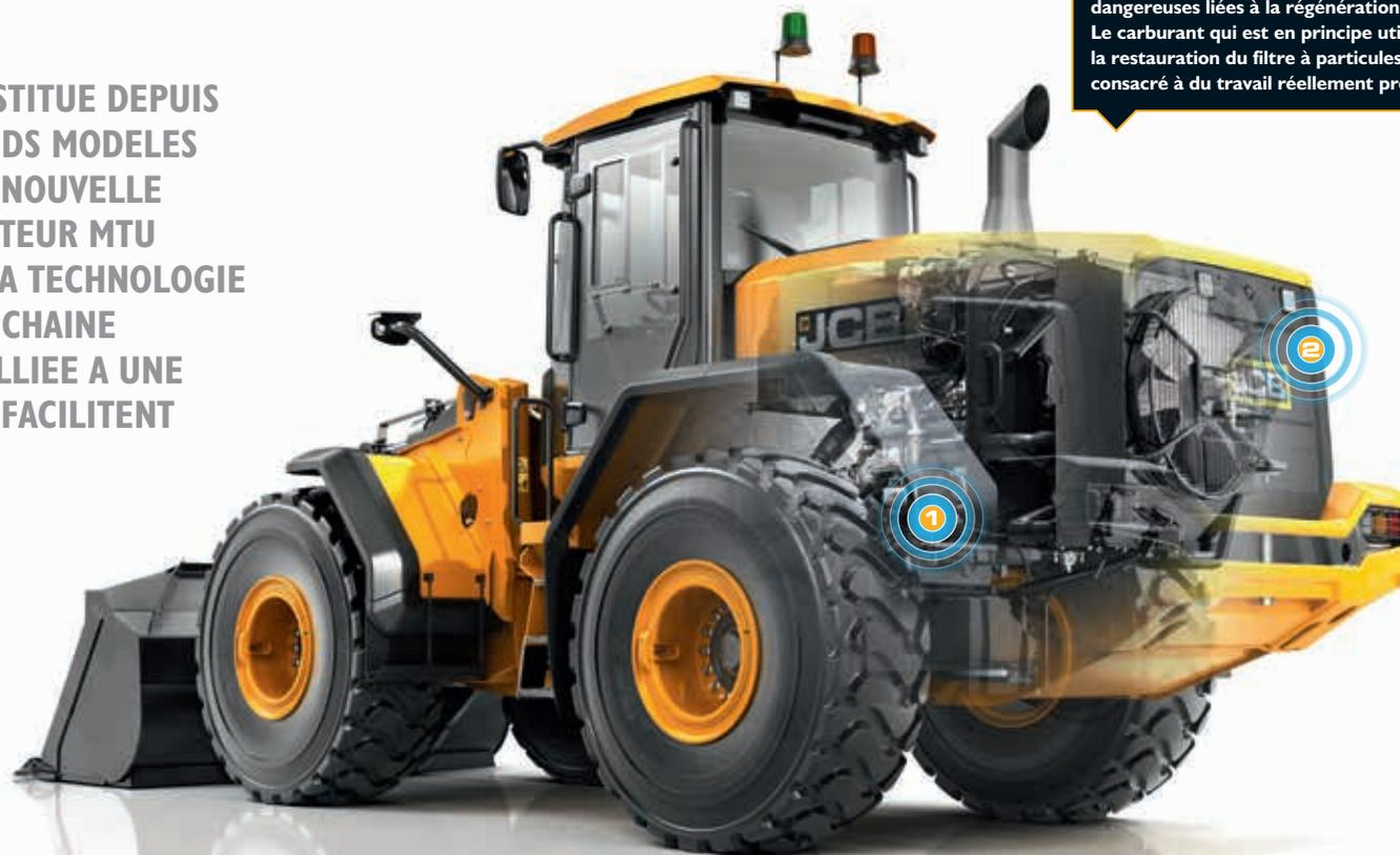
L'absence de filtre à particules évite la tuyauterie de carburant supplémentaire et les températures potentiellement dangereuses liées à la régénération. Le carburant qui est en principe utilisé pour la restauration du filtre à particules peut être consacré à du travail réellement productif.
