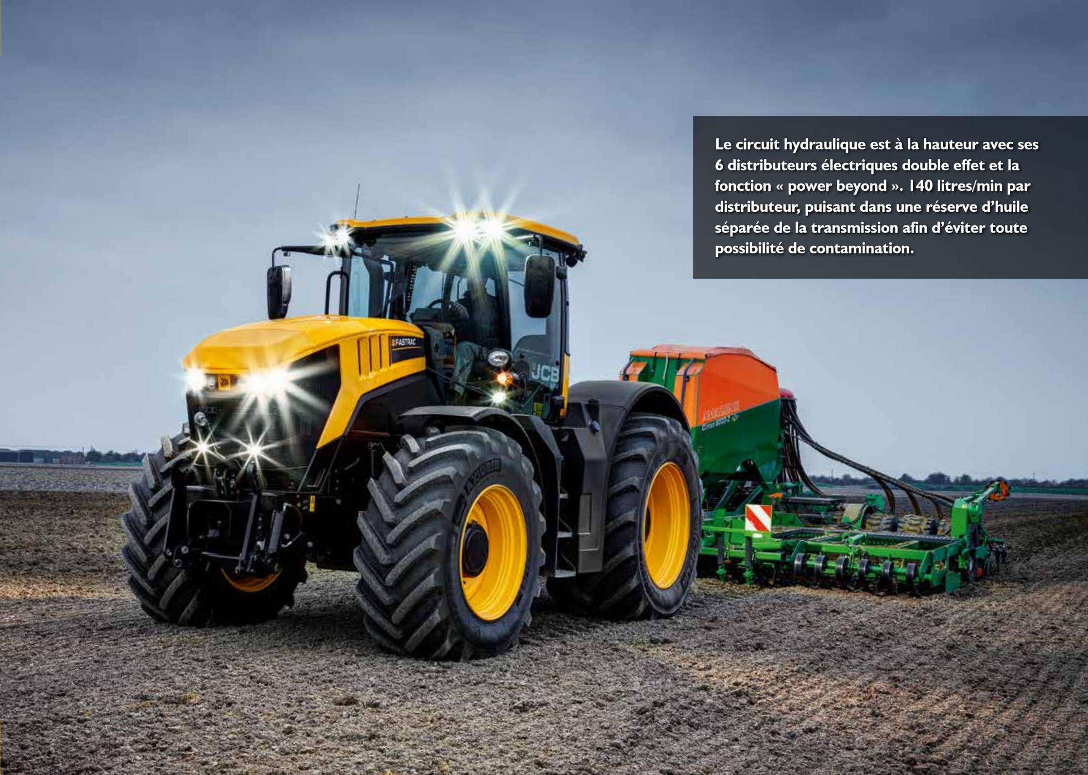
Le circuit hydraulique est à la hauteur avec ses 6 distributeurs électriques double effet et la fonction « power beyond ». 140 litres/min par distributeur, puisant dans une réserve d'huile séparée de la transmission afin d'éviter toute possibilité de contamination.
