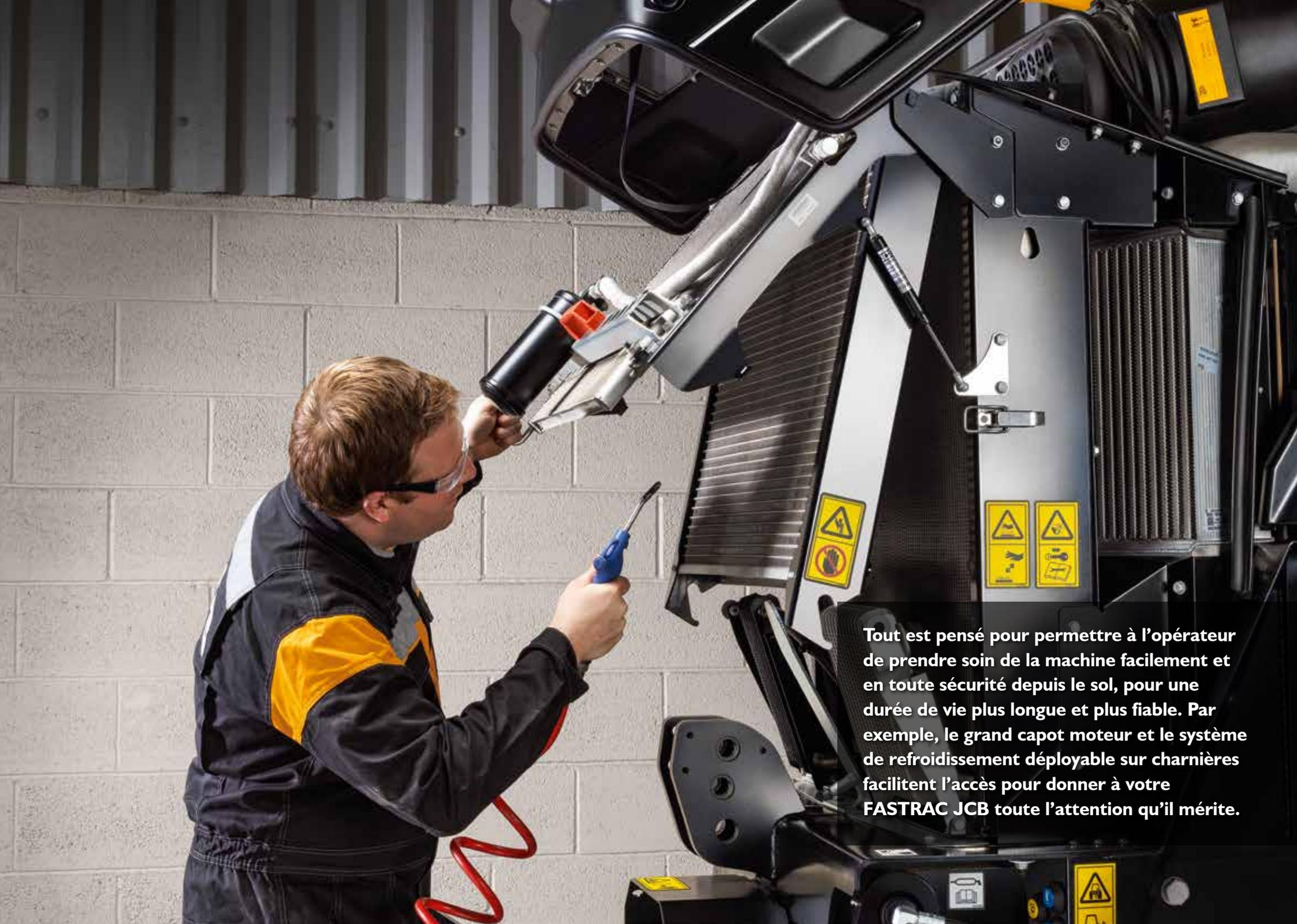
**Tout est pensé pour permettre à l'opérateur de prendre soin de la machine facilement et en toute sécurité depuis le sol, pour une durée de vie plus longue et plus fiable. Par exemple, le grand capot moteur et le système de refroidissement déployable sur charnières facilitent l'accès pour donner à votre FASTRAC JCB toute l'attention qu'il mérite.**
