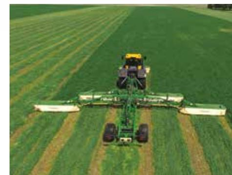
Les ponts robustes peuvent être utilisés avec une largeur de voie de 3 m pour la conduite sur la route et utiliser le **FASTRAC JCB** comme tracteur en inter-rang.
