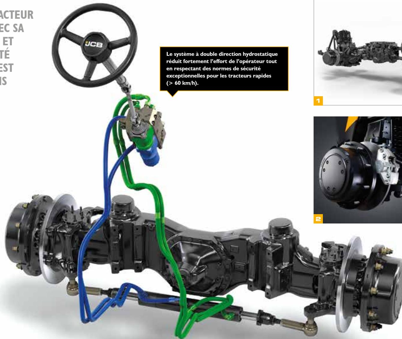
Le système à double direction hydrostatique réduit fortement l'effort de l'opérateur tout en respectant des normes de sécurité exceptionnelles pour les tracteurs rapides (> 60 km/h).
