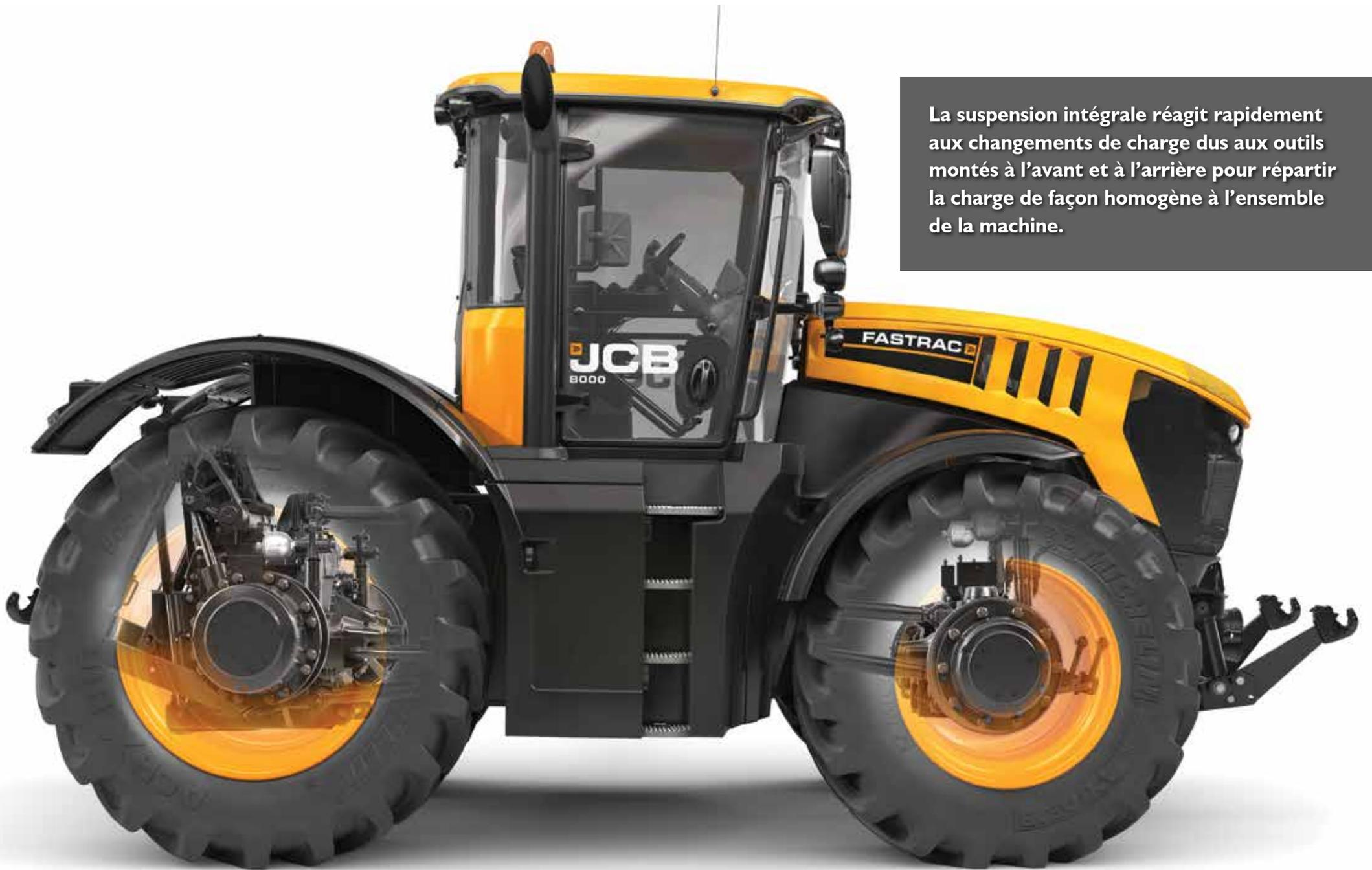
La suspension intégrale réagit rapidement aux changements de charge dus aux outils montés à l'avant et à l'arrière pour répartir la charge de façon homogène à l'ensemble de la machine.
