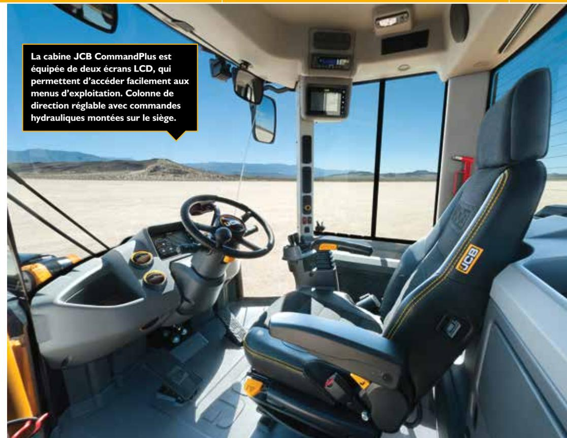
La cabine JCB CommandPlus est équipée de deux écrans LCD, qui permettent d'accéder facilement aux menus d'exploitation. Colonne de direction réglable avec commandes hydrauliques montées sur le siège.
