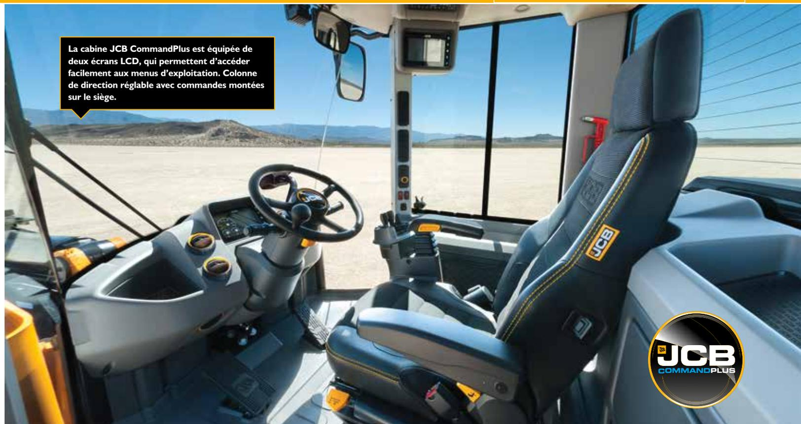
La cabine JCB CommandPlus est équipée de deux écrans LCD, qui permettent d'accéder facilement aux menus d'exploitation. Colonne de direction réglable avec commandes montées sur le siège.
