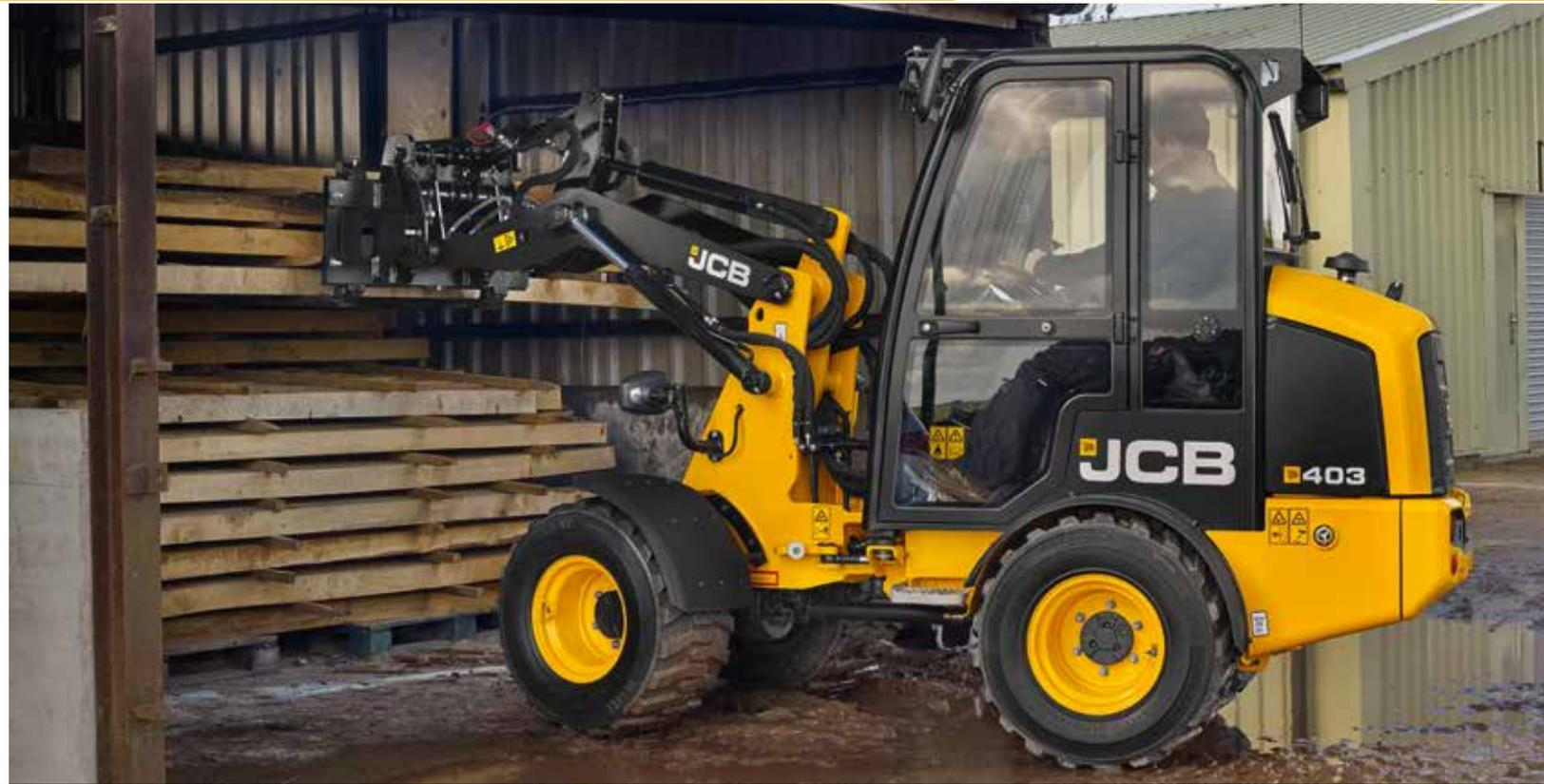
Son faible empattement et son articulation de 45 degrés permettent de garantir un faible rayon de braquage et une maniabilité incomparable
