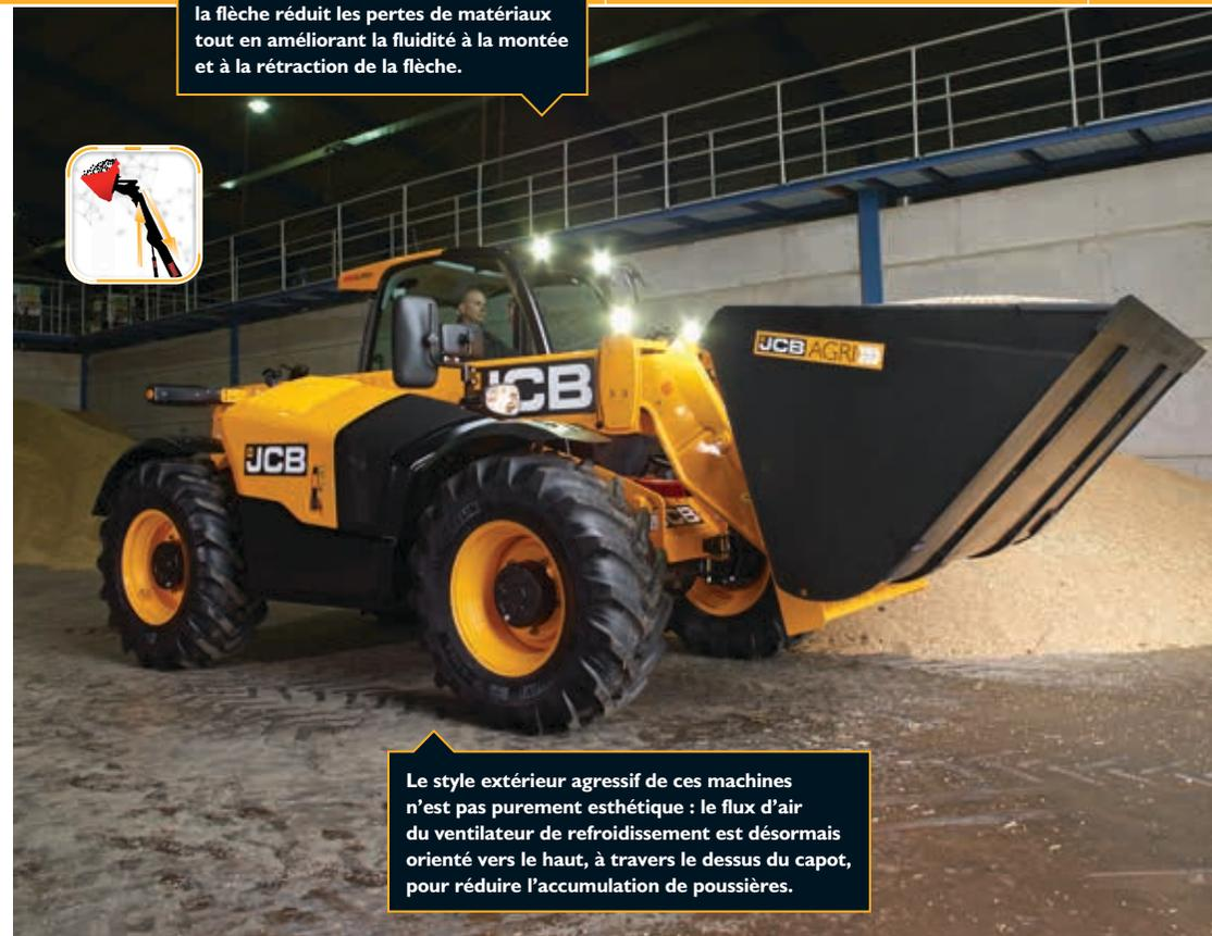
Le style extérieur agressif de ces machines n'est pas purement esthétique : le flux d'air du ventilateur de refroidissement est désormais orienté vers le haut, à travers le dessus du capot, pour réduire l'accumulation de poussières.
