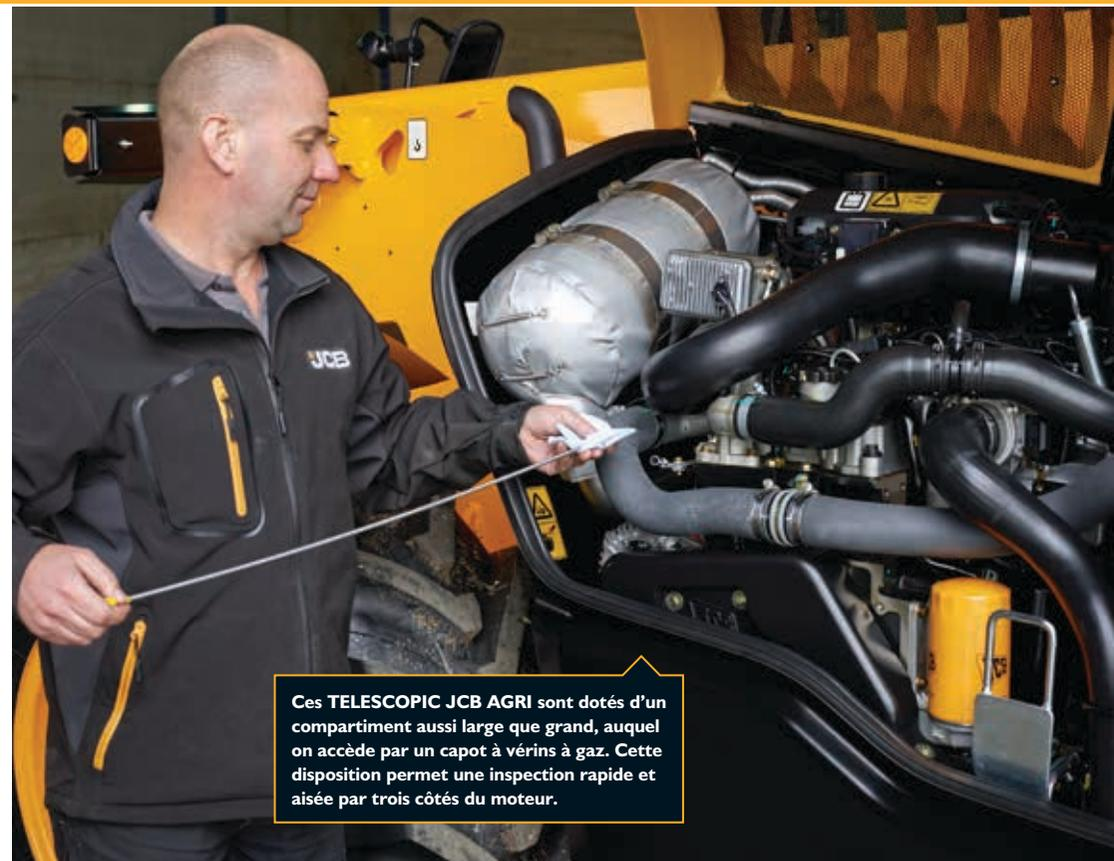
Ces TELESCOPIC JCB AGRI sont dotés d'un compartiment aussi large que grand, auquel on accède par un capot à vérins à gaz. Cette disposition permet une inspection rapide et aisée par trois côtés du moteur.
