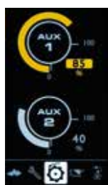
Réglage des débits des circuits auxiliaires
