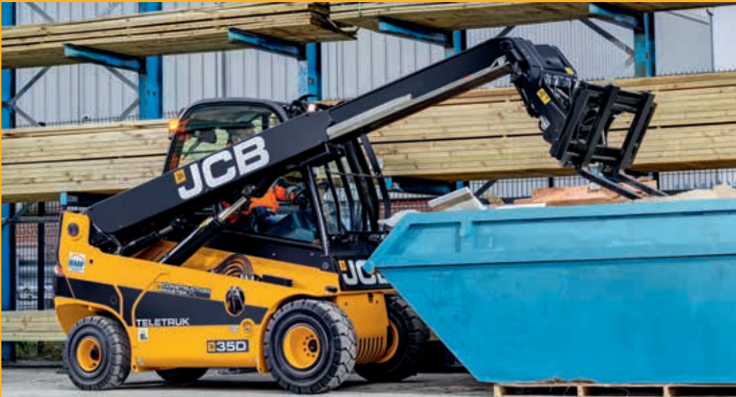
Possibilité d'inclinaison vers l'avant pour le compactage des déchets légers dans la benne.
