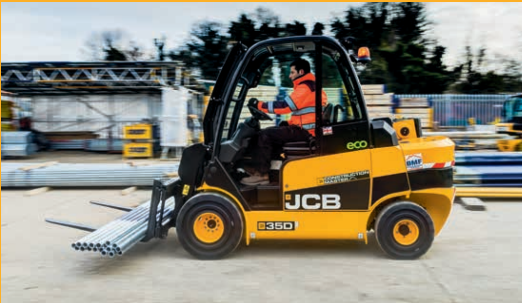
Fourche plus inclinée que sur un chariot élévateur standard.
