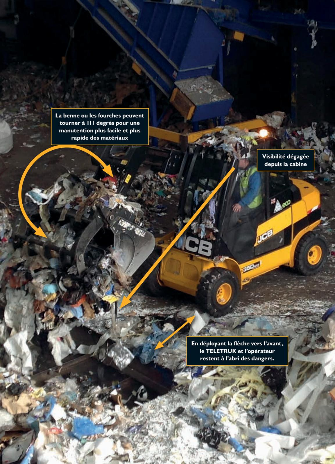
La benne ou les fourches peuvent tourner à 111 degrés pour une manutention plus facile et plus rapide des matériaux
