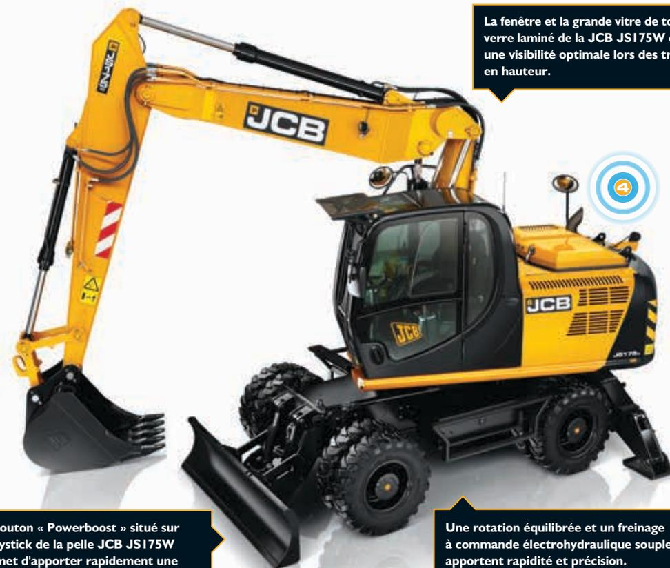
La fenêtre et la grande vitre de toit en verre laminé de la JCB JS175W offrent une visibilité optimale lors des travaux en hauteur.
