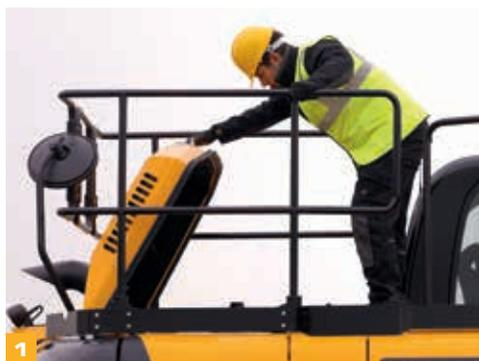
1 Le capot des pelles JSI 30/I45 s'ouvre d'avant en arrière pour offrir un accès facile et sécurisé au moteur.
