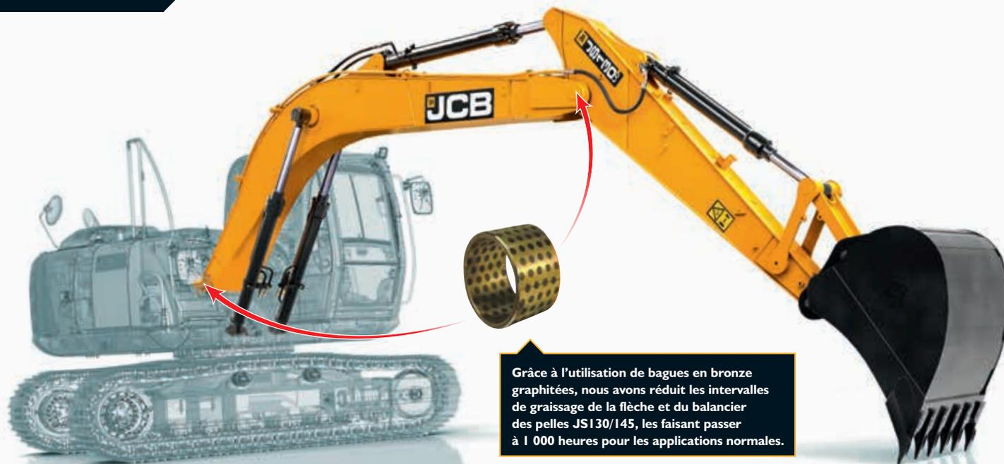
Grâce à l'utilisation de bagues en bronze graphitées, nous avons réduit les intervalles de graissage de la flèche et du balancier des pelles JS130/145, les faisant passer à 1 000 heures pour les applications normales.
