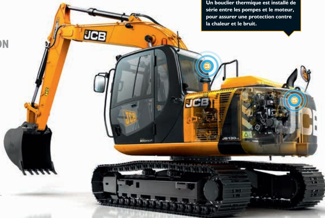
Un bouclier thermique est installé de série entre les pompes et le moteur, pour assurer une protection contre la chaleur et le bruit.
