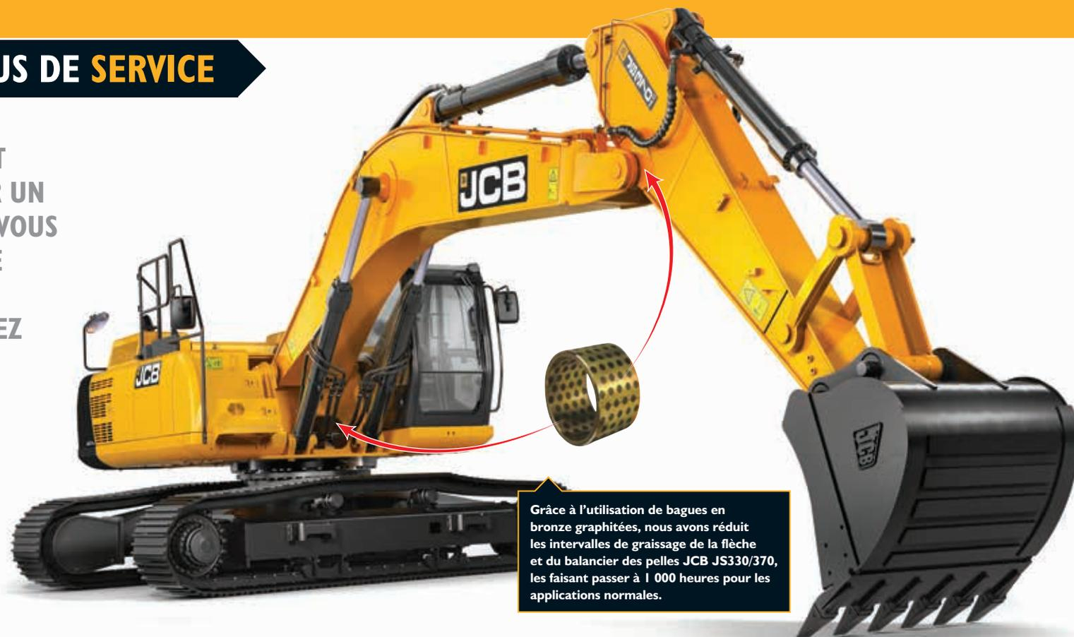
Grâce à l'utilisation de bagues en bronze graphitées, nous avons réduit les intervalles de graissage de la flèche et du balancier des pelles JCB JS330/370, les faisant passer à 1 000 heures pour les applications normales.
