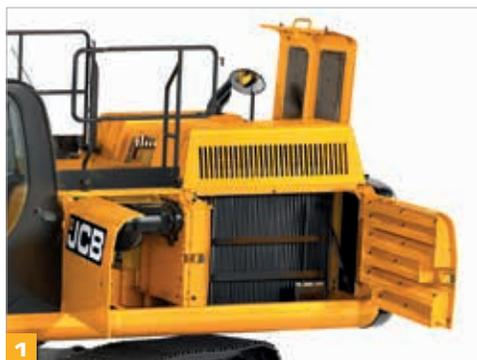
**1** Le capot des pelles JCB JS330/370 s'ouvre d'avant en arrière pour offrir un accès facile et sûr au moteur.
