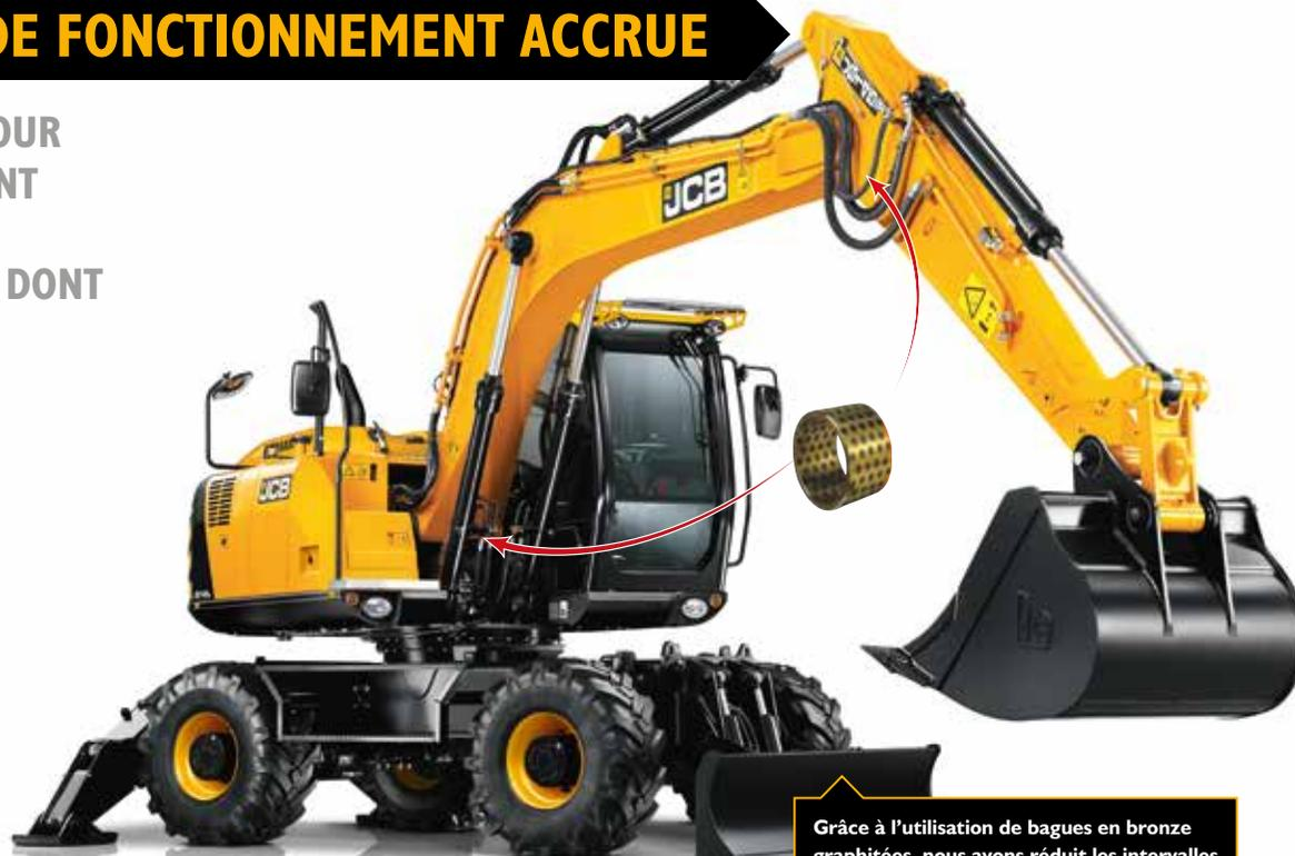
Grâce à l'utilisation de bagues en bronze graphitées, nous avons réduit les intervalles de graissage de la flèche et du balancier des JCB JSI45W/160W à 1 000 heures pour les applications normales.
