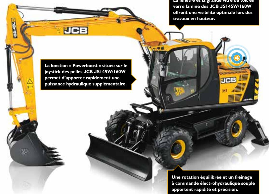
La fenêtre et la grande vitre de toit en verre laminé des JCB JSI 45W/160W offrent une visibilité optimale lors des travaux en hauteur.
