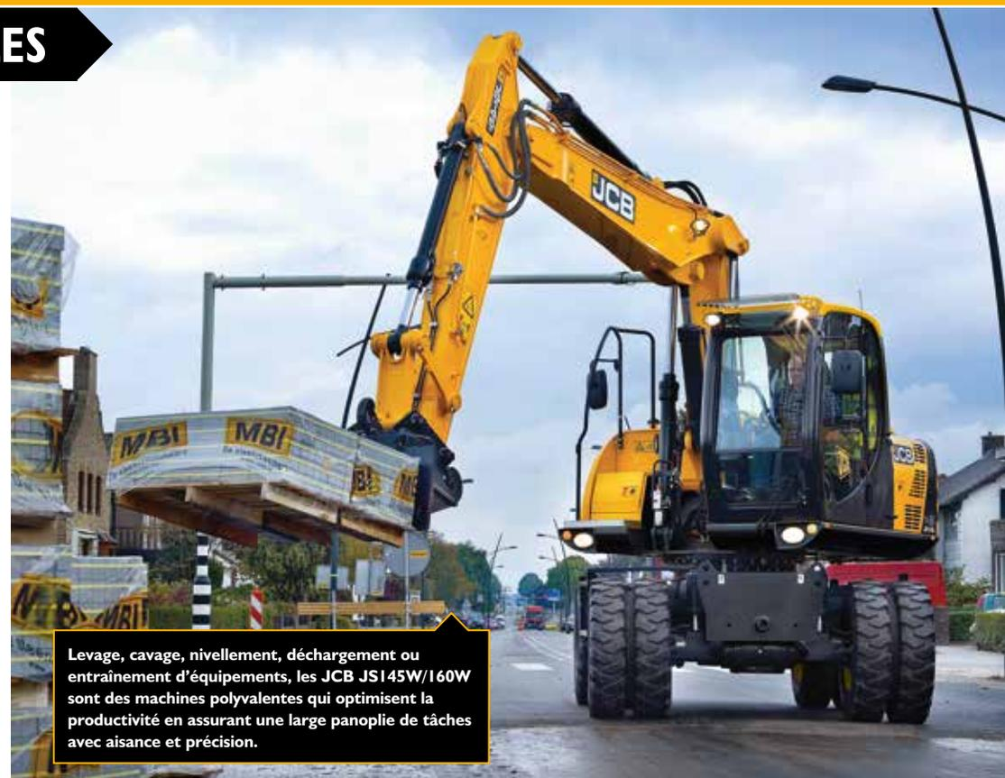
Levage, cavage, nivellement, déchargement ou entraînement d'équipements, les JCB JSI 45W/I 60W sont des machines polyvalentes qui optimisent la productivité en assurant une large panoplie de tâches avec aisance et précision.
