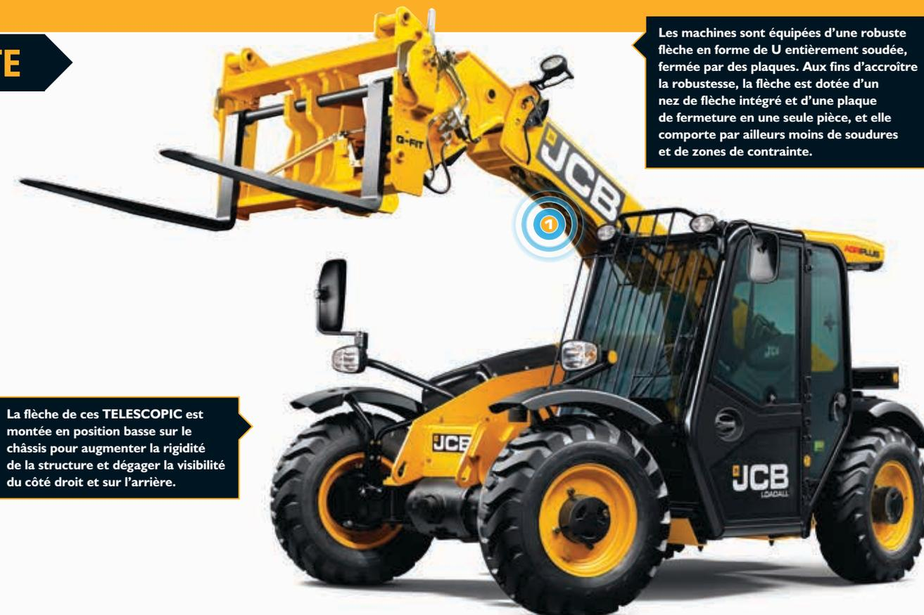
Les machines sont équipées d'une robuste flèche en forme de U entièrement soudée, fermée par des plaques. Aux fins d'accroître la robustesse, la flèche est dotée d'un nez de flèche intégré et d'une plaque de fermeture en une seule pièce, et elle comporte par ailleurs moins de soudures et de zones de contrainte.
