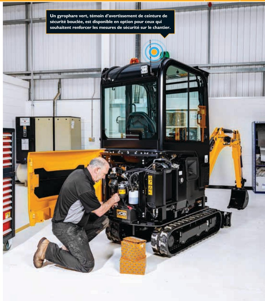
Un gyrophare vert, témoin d'avertissement de ceinture de sécurité bouclée, est disponible en option pour ceux qui souhaitent renforcer les mesures de sécurité sur le chantier.
