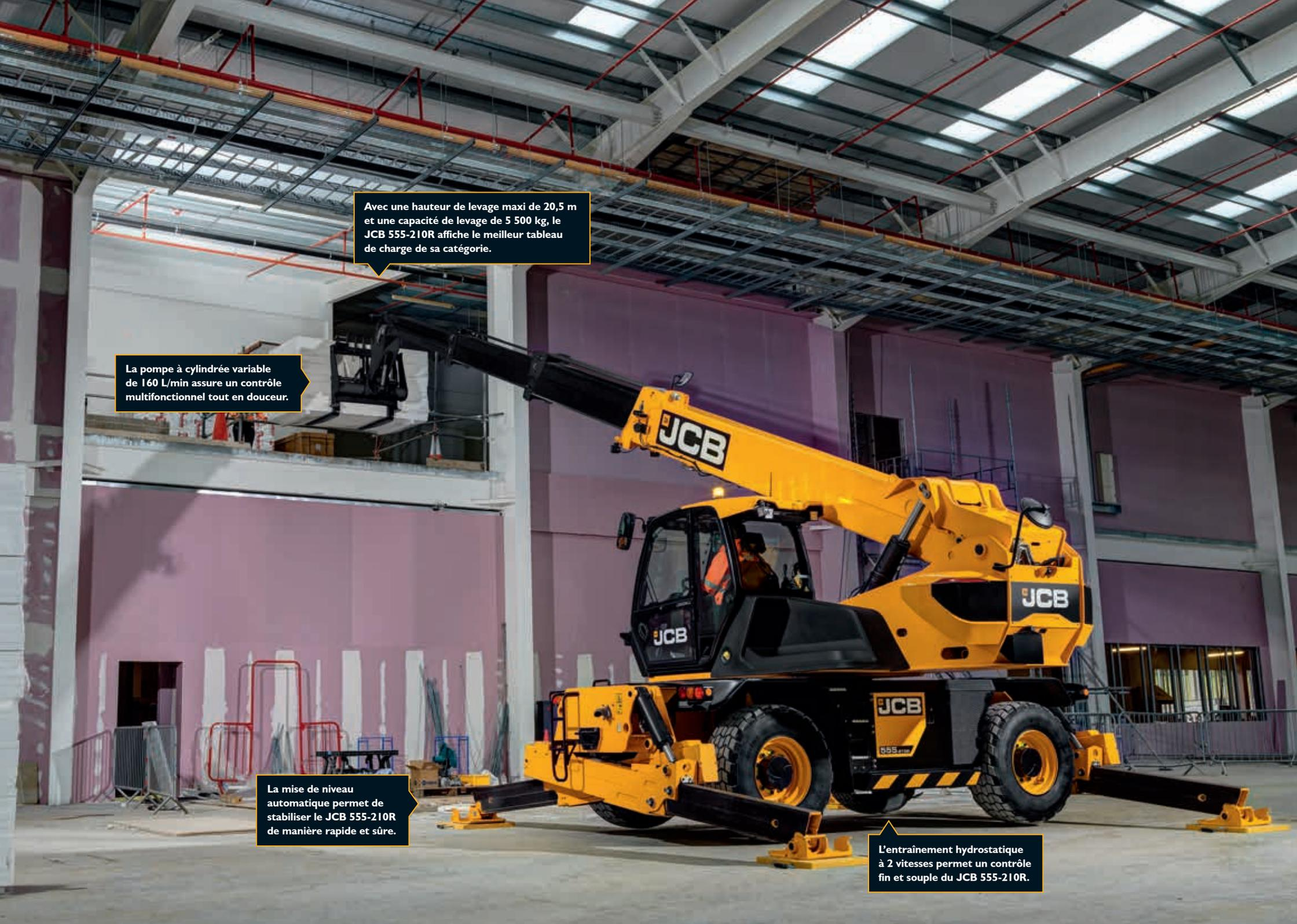
Avec une hauteur de levage maxi de 20,5 m et une capacité de levage de 5 500 kg, le JCB 555-210R affiche le meilleur tableau de charge de sa catégorie.
