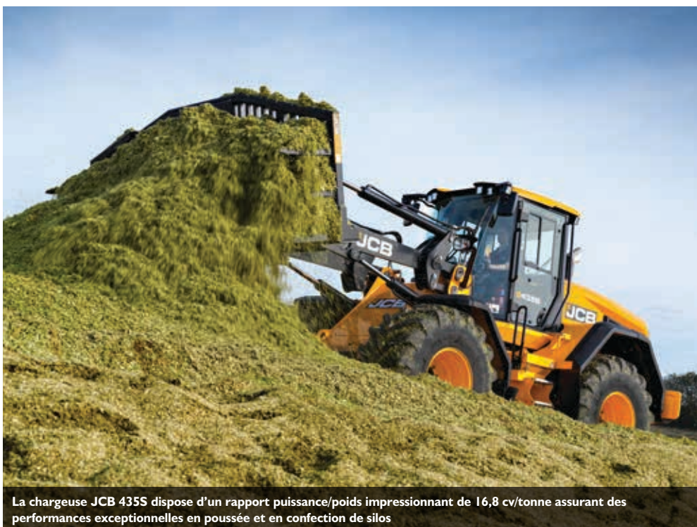
Le circuit hydraulique de 264 l/min garantit des cycles rapides
