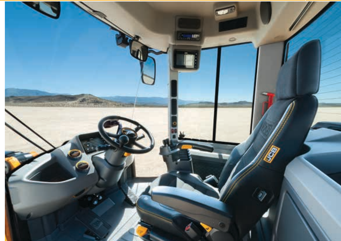
La cabine JCB CommandPlus est équipée de deux écrans LCD, qui permettent d'accéder facilement aux menus d'exploitation. Colonne de direction réglable avec commandes hydrauliques montées sur le siège
