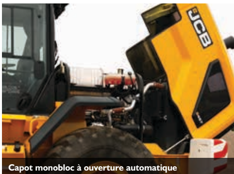
Capot monobloc à ouverture automatique
