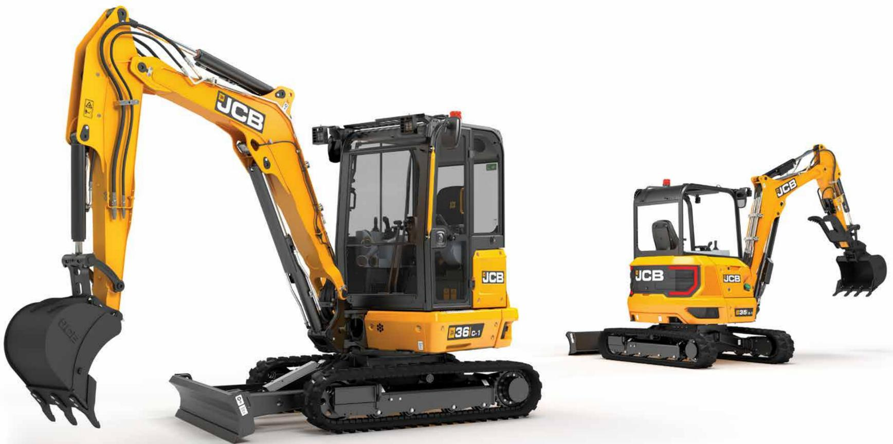
**Nouvelles mini-pelles Stage V : la 35Z-I avec zéro déport arrière et la 36C-I avec déport conventionnel.**
